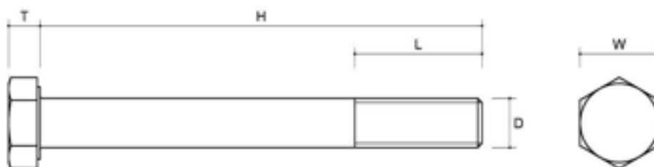
Rysunek 68 Typ śruby M12x35
